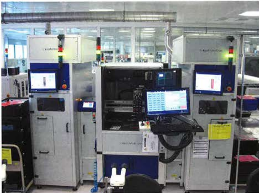
Bild 3 Da der Platz in der Reinraumproduktion teuer ist, sollten die Anlagen möglichst kompakt stehen. Der Hochstapler von ic-automation ermöglicht die optimale Ausnutzung der Fläche.
