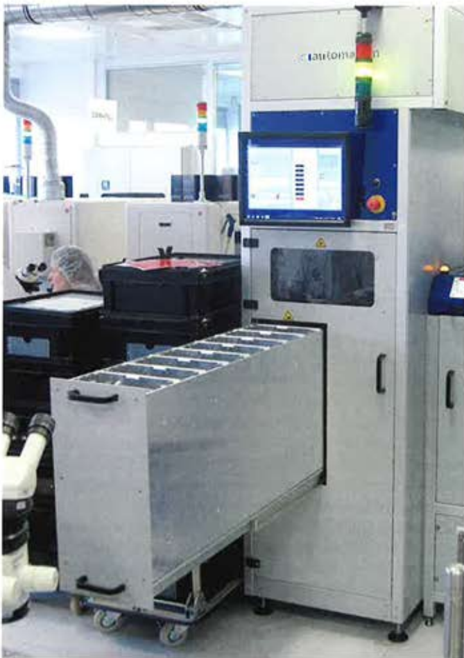
Bild 1 In den Schubladen des Bestückungsautomaten lassen sich bis zu 42 Kassetten mit Platinen übereinander stapeln.
