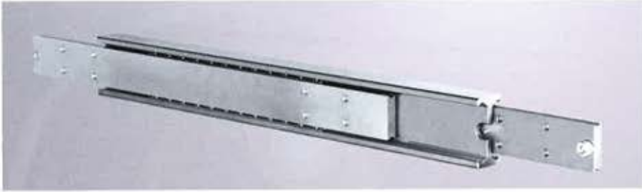
Bild 2 Die Schwerlastauszüge von Rollon weisen eine geringe Durchbiegung und eine hohe Systemsteifigkeit auf. Sie erreichen Hübe von 100 % der Teleskopschienenlänge.
