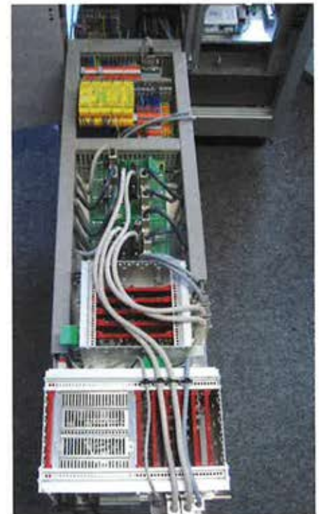
Bild 4 Dank der Schwerlastauszüge von Rollon finden in den Schubladen des Hochstaplers alle Rechner und Netzteile bequem Platz. (Bilder 1, 3, 4: ic-automation)
