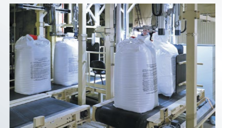
Автомат запайки биг бегов компании ВСЕЛУГ с компонентами Rollon.
