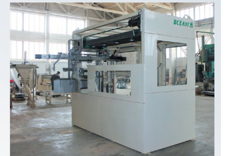
Автомат насадки мешков компании ВСЕЛУГ с компонентами Rollon.
